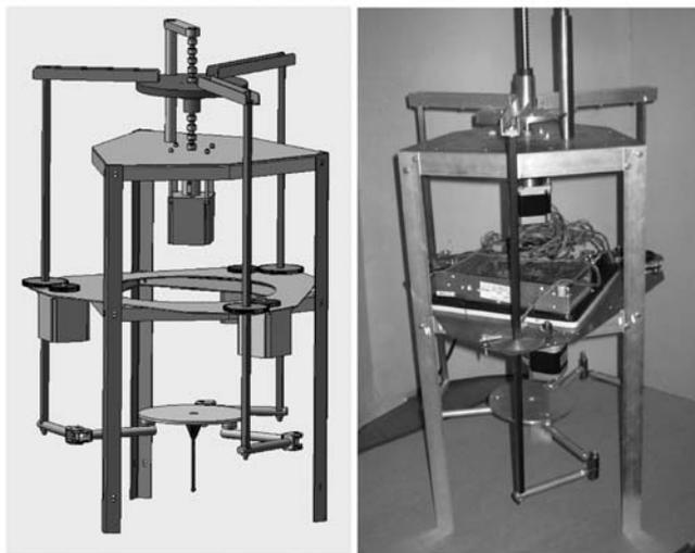
**Рис. Твердотельная программная модель (слева) и физическая модель (справа) экспериментального манипулятора параллельной структуры**
