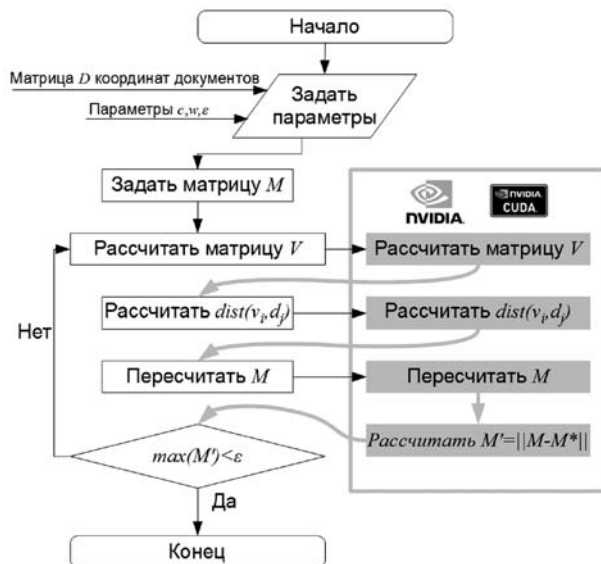
Рис. 2. Блок-схема алгоритма Fuzzy C-Means с использованием GPU
