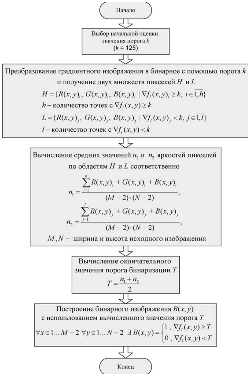
Рис. 2. Алгоритм бинаризации изображения при помощи глобального порогового оператора.
