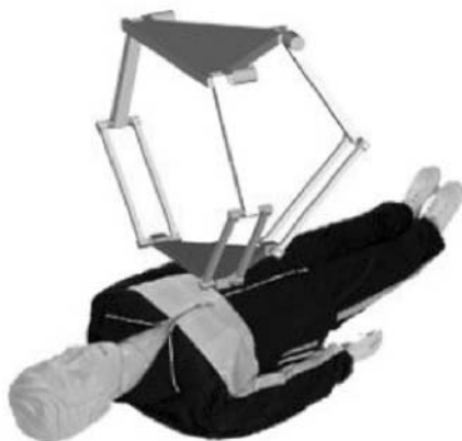
Рис. 5. Модель модифицированного робота DELTA, применяемого для сердечно-лёгочной реанимации [10].
