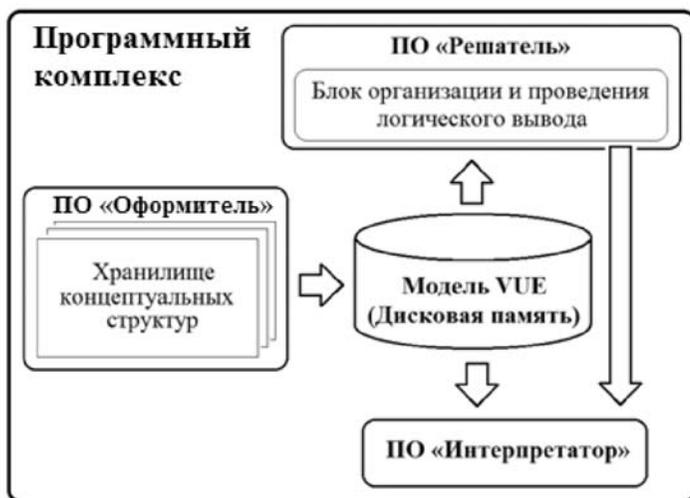
Рис. 4. Архитектурная схема программного комплекса.
